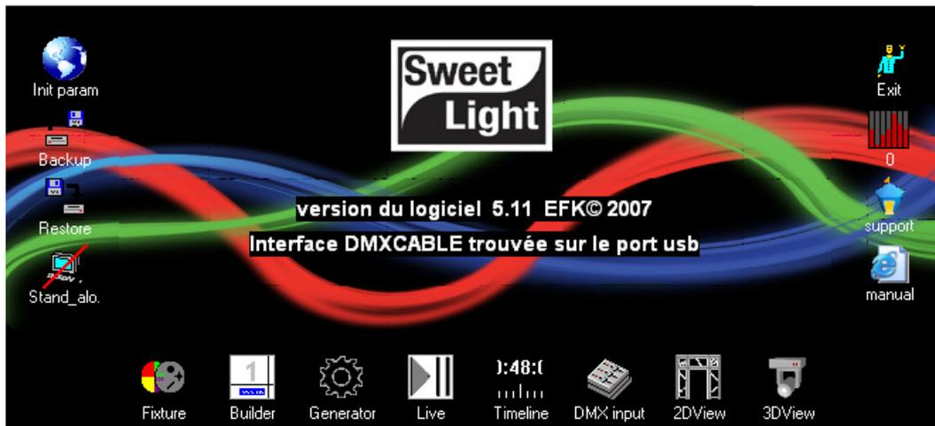
Le Control Board est une fenêtre d'accès à tous les modules de Sweetlight. Cette fenêtre doit toujours être ouverte lors de l'utilisation du logiciel. Elle indique entre autre la version du logiciel en cours (ici le 5.11 EFK 2007) et l'interface détectée.
